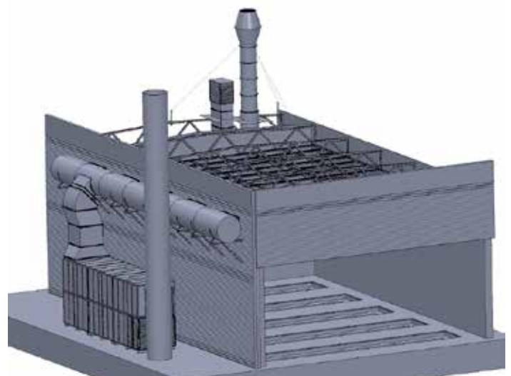
Docka för flygplansmålning med zonindelad vertikal ventilation
