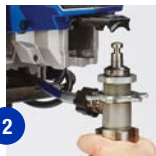
2 Öppna luckan och avlägsna pumpen
