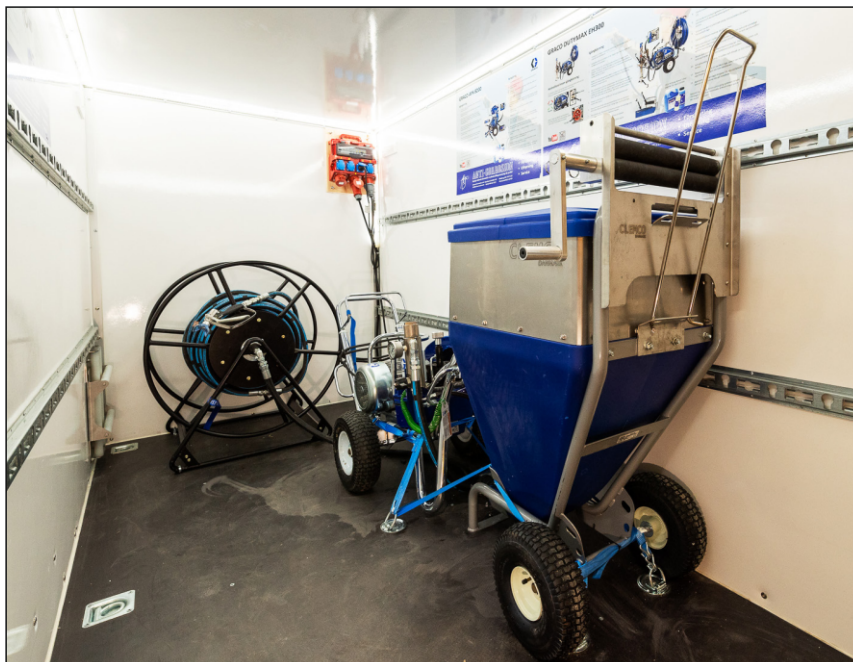
Den mobila arbetsstationen är värmeisolerad och med värmeflärten (2000W) kan man behålla viss grundtemperatur i vagnen på frostfri nivå.
