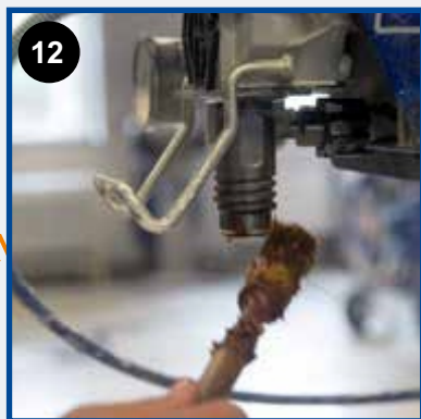
Gängor smörjs in med fett för lättare demontering vid nästa service.
