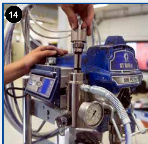
Filter, sugsil och sprutslang, kopplingar (säkerhetsdetalj) kontrolleras.
