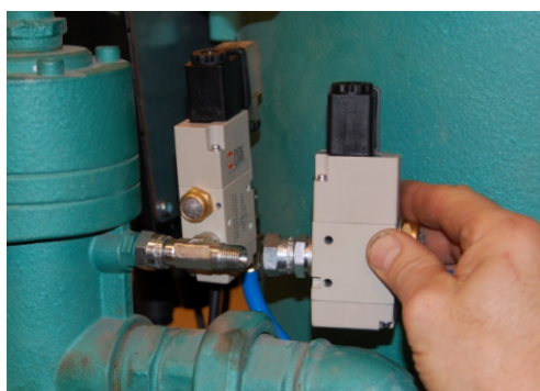
Återmontera magnetventil för start/stopp
