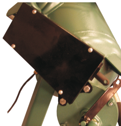
Montera ställdonet på ventilens två övre bultpars undersida.
