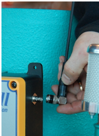
Antennkabeln ansluts till mottagaren.
