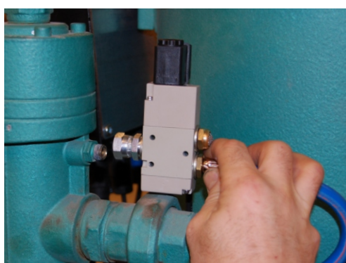
Demontera magnetventil för start/stopp
