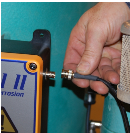
Montera förlängningskabeln på mottagaren
