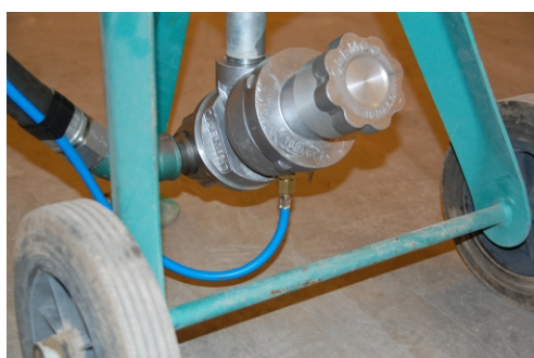
Exempel på luftslangens anslutning på sandventil
