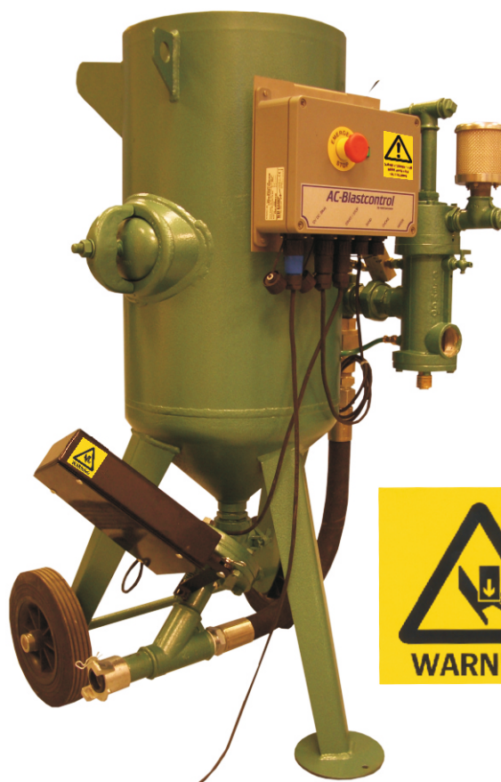
Färdigkopplad utrustning med fjärrstyrd sandreglering.
