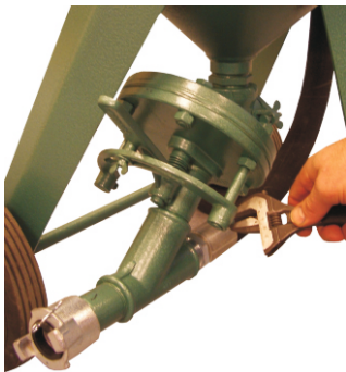
Ta bort bygeln med justerskruv från sandventilen.
