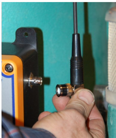
Demontera den fasta antennen från mottagaren
