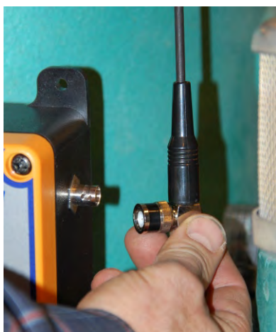
Demontera den fasta antennen från mottagaren
