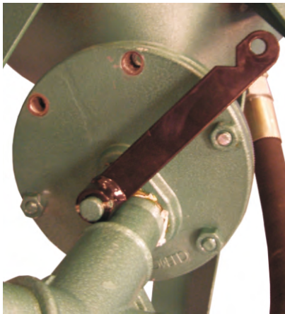
Byt plats på skruvarna så det övre bultparet blir ledigt.
