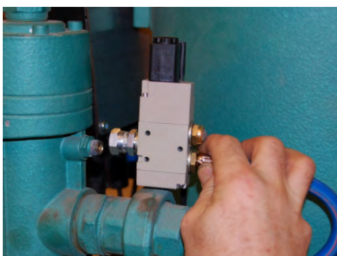
Demontera magnetventil för start/stopp
