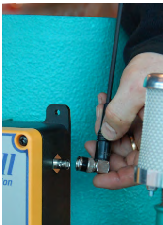
Antennkabeln ansluts till mottagaren.
