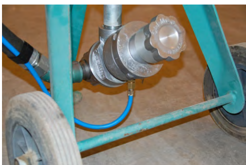
Exempel på luftslangens anslutning på sandventil
