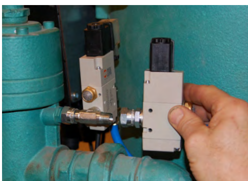
Återmontera magnetventil för start/stopp
