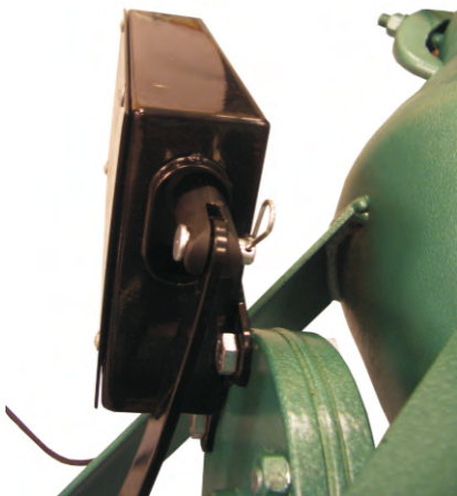
Anpassa spaken till armen och montera sedan bult och låssprint.
