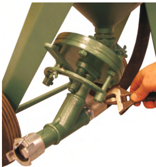
Ta bort bygeln med justerskruv från sandventilen.
