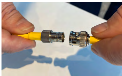
Montera ihop förlängningskabeln och magnetfoten.
