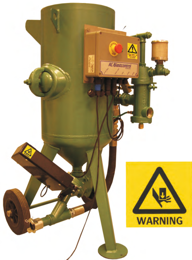
Färdigkopplad utrustning med fjärrstyrd sandreglering.
