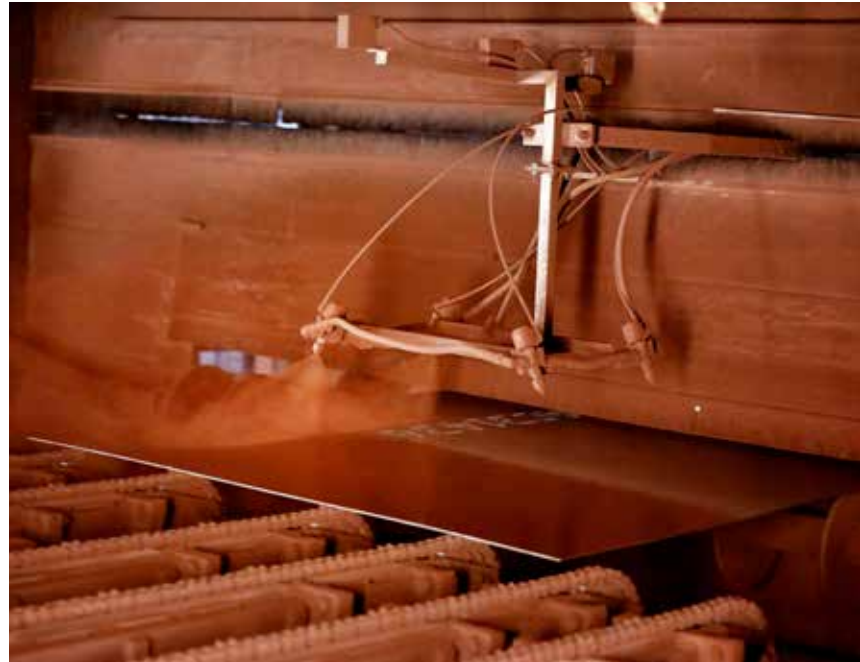
Stålplåten målas med ett tunt lager färg, 12–15 \mu .
